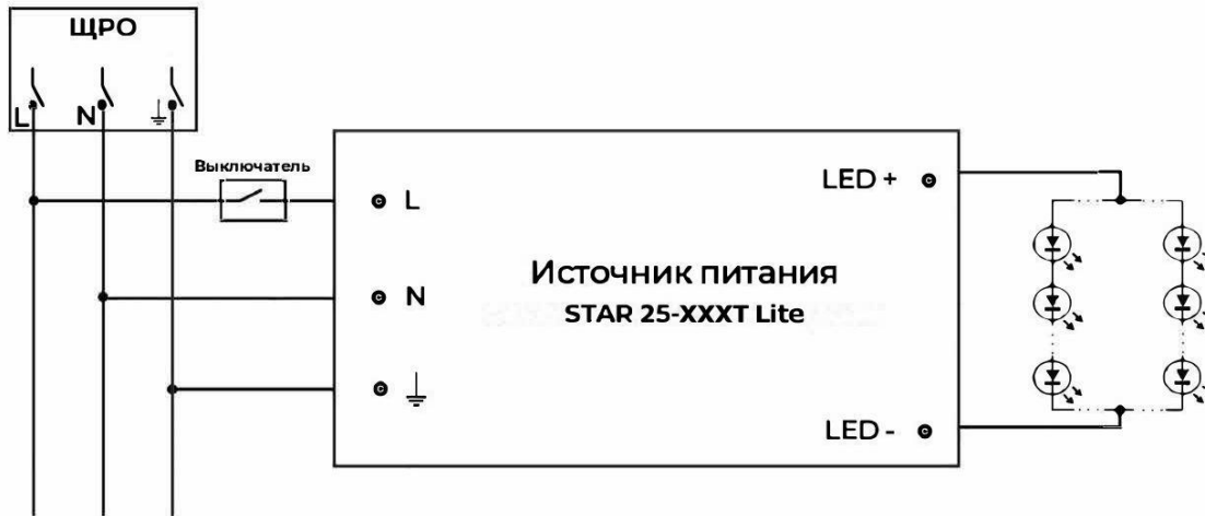
Рисунок 3 – Схема подключения источника (на примере STAR 25-350T Lite)
