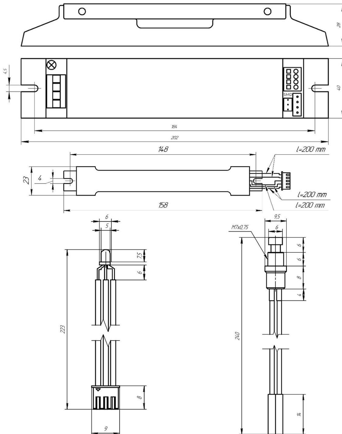
Рисунок 1 – Габаритные размеры источника STAR 50-350T-L3 Neuron
