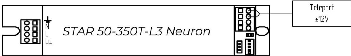
Рисунок 4 - Схема подключения УДТУ Teleport
