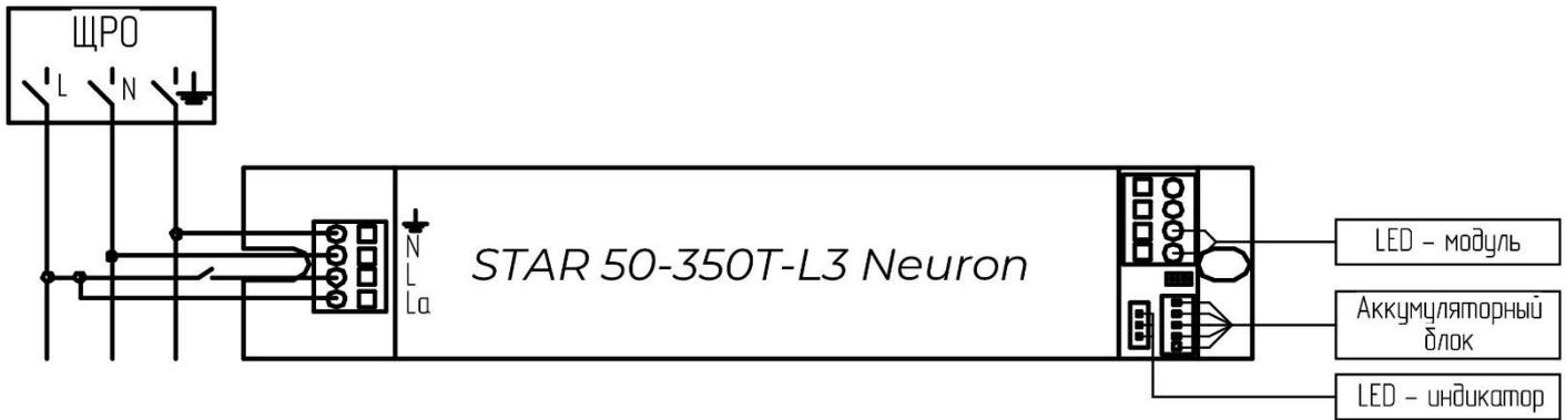
Рисунок 2 – Схема подключения источника
