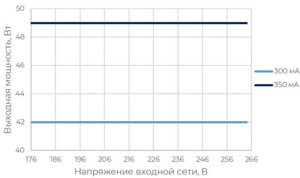
Рис. 1 - Зависимость выходной мощности от напряжения входной сети
