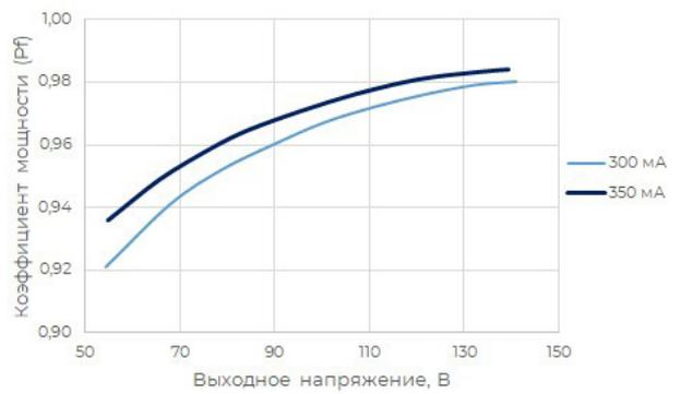
Рис. 2 - Зависимость коэффициента мощности от выходного напряжения
