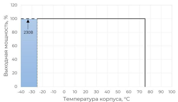
Рис. 6 - Зависимость выходной мощности от температуры корпуса
