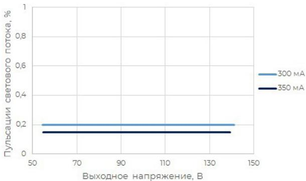
Рис. 3 - Зависимость пульсаций светового потока от выходного напряжения
