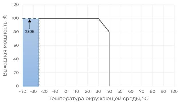
Рис. 5 - Зависимость выходной мощности от температуры окружающей среды
